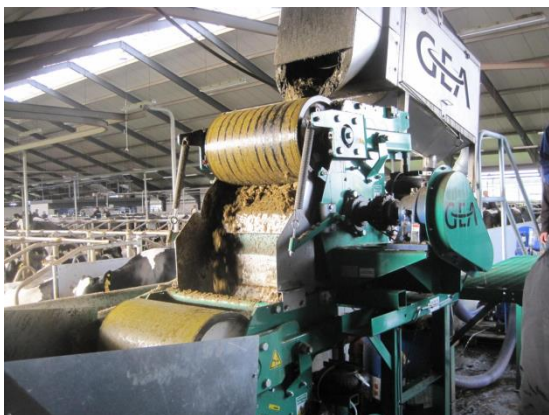
Bild 1: Valsverk som separerar fiberfraktionen ur kogödsel
